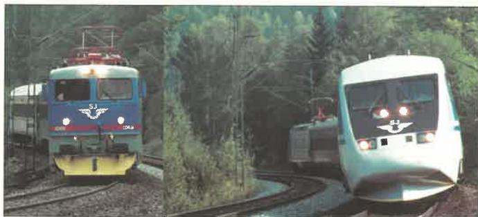
**El tren pendular X-2000 incorpora las técnicas más avanzadas, ajustando su inclinación al tomar las curvas (excepto la locomotora, que empuja desde atrás) (Foto: S.J.).**
